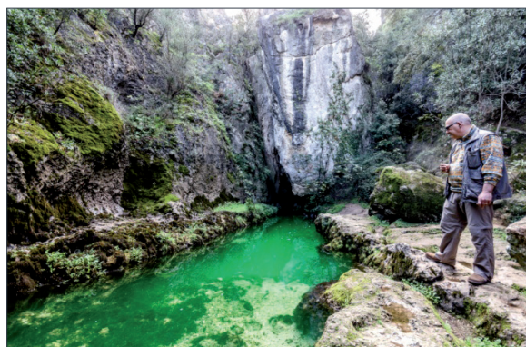
Foto 4 - Colorazione effettuata nel 2013 nel sifone della grotta di Su Bentu; i traccianti riemergono dalle sorgenti di Su Gologone (foto Bobore Frau).
