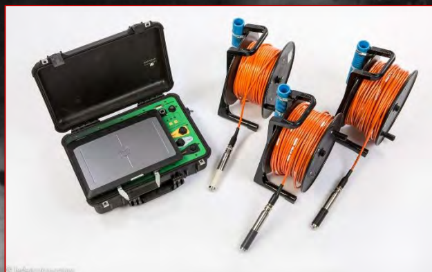
STRUMENTAZIONE INDAGINI SU PALI
