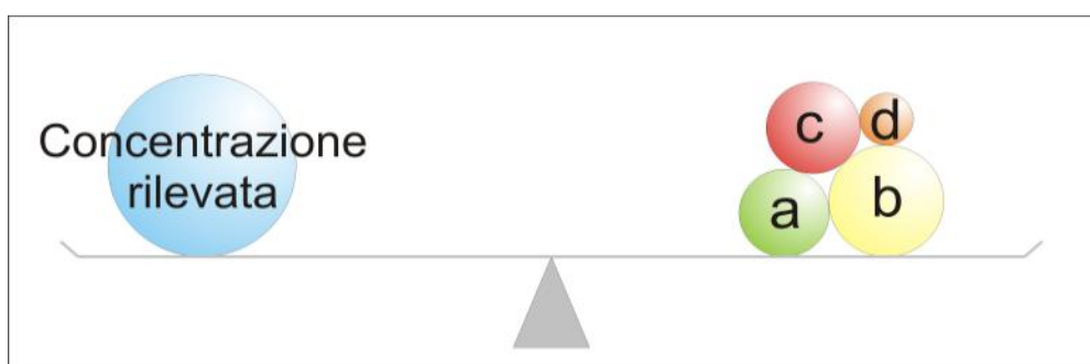
Figura 2. La concentrazione di un potenziale contaminante rilevata in campo può essere data da quattro componenti non tutte necessariamente presenti nel campione. Esse derivano da sorgenti: a) naturali, b) antropiche diffuse, c) antropiche puntuali in sito d) antropiche puntuali extra sito. La determinazione di VFN e VFA, può concorrere, insieme allo sviluppo del MC, ad individuare alcune di queste componenti.
