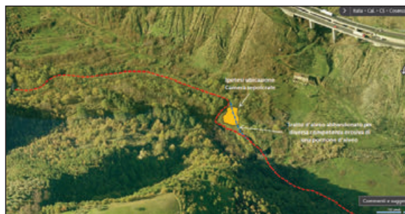
Figura 1 – Ipotesi di spostamento di un tratto d'alveo (t. Iassa) per differente resistenza erosiva dei volumi alluvionali in alveo: sito 4J.
