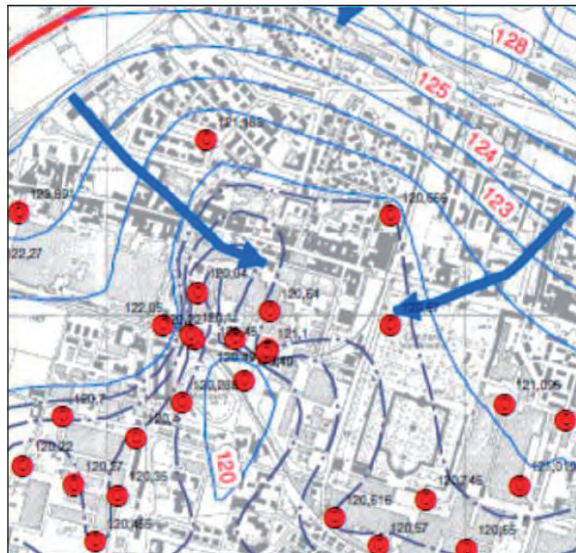
Figura 7 - Cono di depressione prodotto dall'emungimento del pozzo A2A Chiesanuova 2
